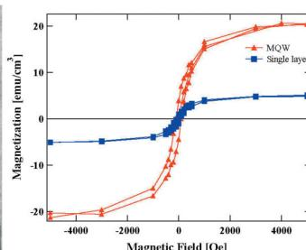
**磁性・ピエゾハイブリッド薄膜の磁気光学効果**
