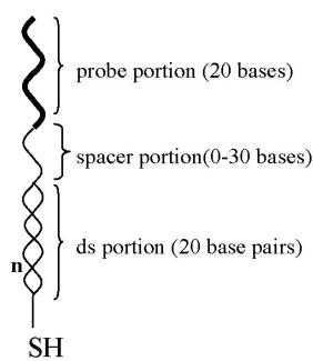
ために、その分子の「スペーサー」部分の長さを調節した。このプローブ DNA が、チオール基で終端された金表面上に固定化されて SAM 膜を形成される過程を表面プラズモン共鳴(SPR) 法で観測した。さらに、ターゲット DNA とプローブ DNA との結合の様子も SPR 法で観測して、スペーサー部分の最適な長さを決定した。
