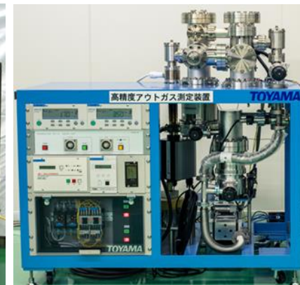
LICA-MS (リアルタイムガス分析装置) 高精度アウトガス測定装置
