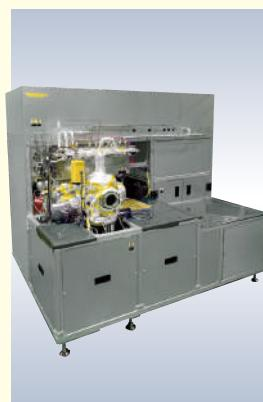
真空チャンバーでウェハを加熱、CVDガスを導入し表面反応を利用したCVD(ALCVD)を行う装置です。メタルオーガニック(MO)ガスを導入したMOCVDや飽和表面反応を利用した原子層成膜(Atomic Layer Deposition)の実験も可能です。
