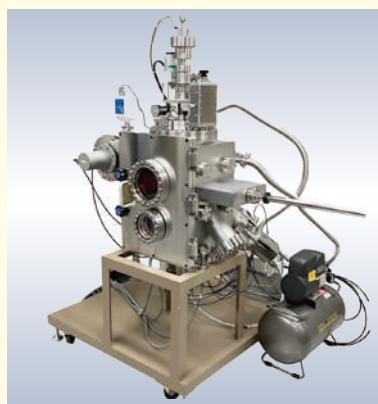
4元式抵抗加熱蒸着方式で金属や酸化物を加熱して蒸発させ試料表面に堆積させて成膜を行います。予備ポート4個有り、スパッタ、EB蒸発元がつけられます。
