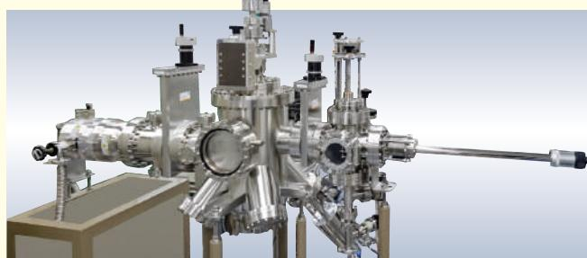
実験用薄膜作成用2インチ小型スパッタ装置です。
