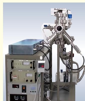
実験用薄膜作成用2"小型スパッタ装置です。各種材料に応じた電源との組み合わせが可能です。
