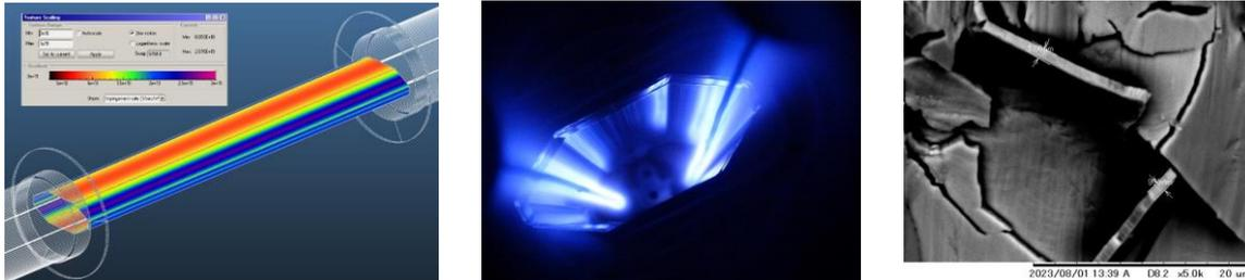
図: Molflow+によるコーティングシミュレーション (左), 非円筒真空ダクト内面へのスパッタリングの様子 (中央), 成膜面スクラッチ後の表面 SEM 観察 (右)
