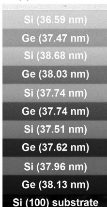
図(a) Si/Ge多層薄膜
