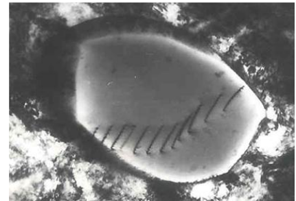
図3. スチールのなかの転位の TEM 像. Wikimedia Commons (Wikityke at the English language Wikipedia)より転載.
